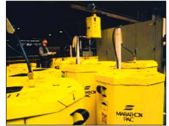
Рис. 2. Транспортировка упаковки Marathon Pac мостовым краном.
